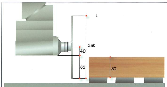
Gracias a las reducidas dimensiones del electromandril de 5 ejes, Prisma K, pueden realizarse trabajos horizontales sin levantar el tablero aprovechando al máximo la carrera Z, así como realizar cortes de la hoja en tableros de gran grosor.
