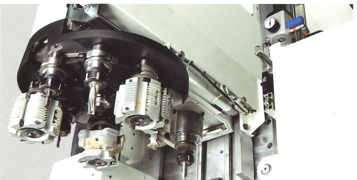
**PBTC:** unità di fresatura ausiliaria con cambio utensili automatico per velocizzare il processo produttivo.
