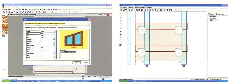
Per una produzione flessibile di finestre è necessario disporre di un sistema pratico, veloce ed intuitivo, che permetta di adattarsi in maniera rapida al variare delle dimensioni di ogni singola finestra. TVN SET è la piena risposta a questa esigenza. Attrezzato il piano con ventose o morsetti, al variare delle dimensioni del prodotto, è sufficiente modificare le quote nel programma parametrico e le barre si configurano per le nuove dimensioni.
