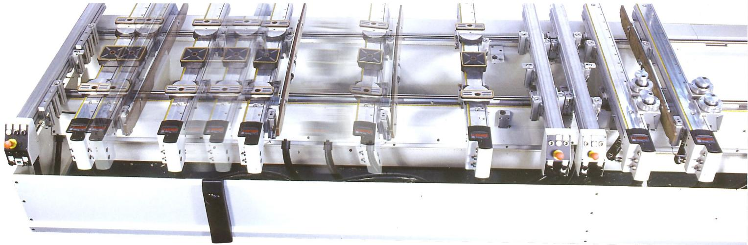
TVN SET è il sistema ideale per il posizionamento automatico delle barre, per chi produce pezzi lineari: porte, finestre, scale, travi, colonne. Estremamente semplice ed intuitivo, coniuga la flessibilità del posizionamento manuale con l'automatismo della gestione da CNC.
