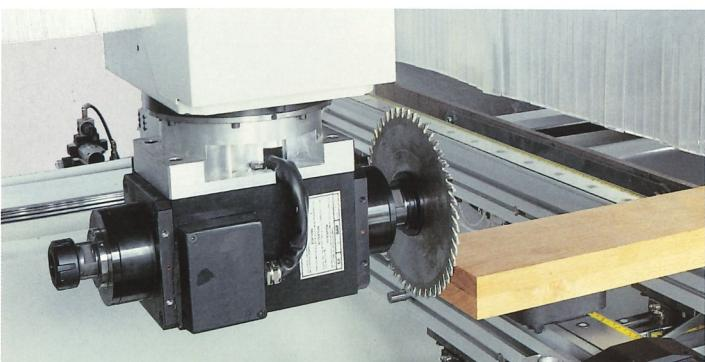
**Universal M2.** Modulo aggregato con asse orizzontale interpolante a 360°. La soluzione definitiva per chi necessita di potenza nelle lavorazioni orizzontali.
