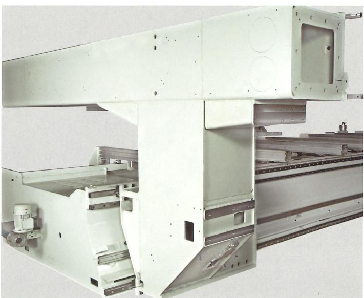
Basamento e montante mobile sono realizzati in carpenteria di acciaio eletrosaldato e stabilizzato con lamiere di grosso spessore ed opportune nervature di irrigidimento. Tutte le lavorazioni meccaniche vengono eseguite su centri di lavoro CNC in un unico posizionamento per garantire le rigorose tolleranze di planarità, perpendicolarità e precisione.
