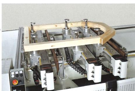
Mordazas con movimiento de rotación y traslación y alzadores de doble movimiento, permiten colocar fácilmente las hojas que se han de escuadrar.
