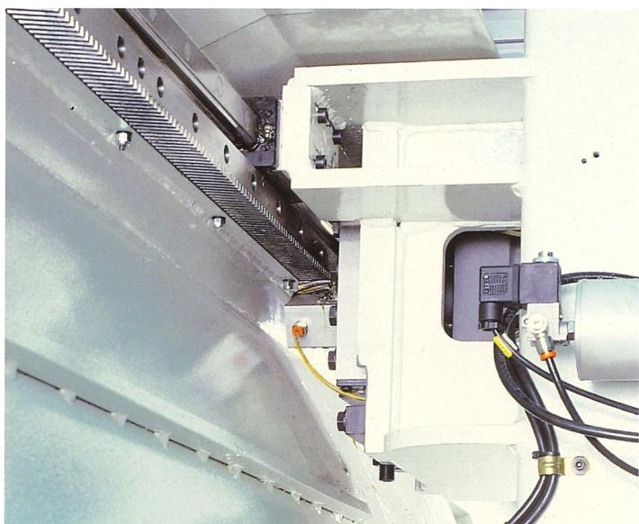
Creamagliere a denti elicoidali per la massima precisione nei movimenti ad alta velocità.
