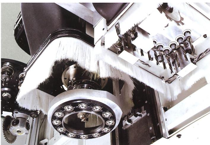
Pressatore meccanico con sfere, coassiale all'utensile, per ricavare da nesting anche pezzi di piccole dimensioni. La forza d'esercizio è regolata pneumaticamente.
