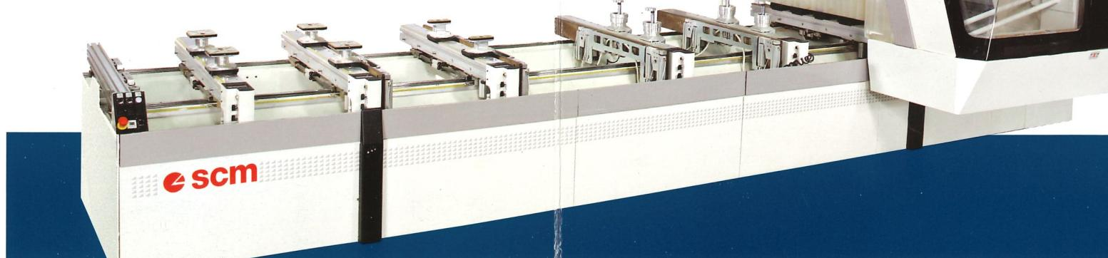
Record 240 NT TVN è la soluzione ideale per chi necessita un sistema pratico e flessibile per fissare, con rapidità e solidità, dai pezzi stretti a quelli larghi, dagli elementi diritti a quelli ad arco, grazie alla possibilità di attrezzare le barre sia con ventose per il vuoto che con morsetti pneumatici.
