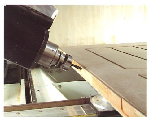
Prisma permette di utilizzare lo stesso utensile in posizione orizzontale, verticale o su piani inclinati eliminando tutti gli aggregati, riducendo l'impiego del cambio utensile e velocizzando la produzione.
