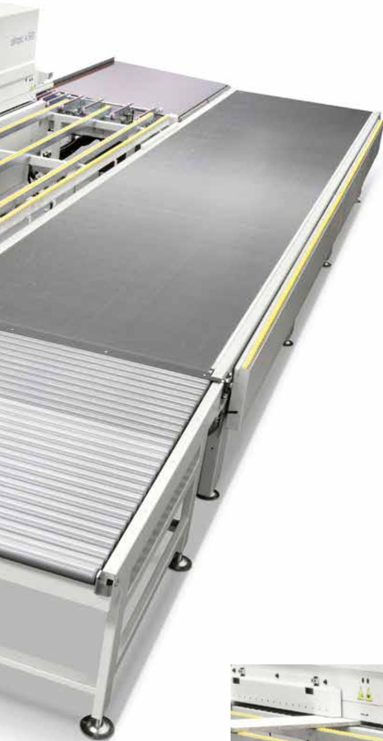
*Es ist einfach mit der automatischen Fastback Werkstückrückführung an den Bediener, die Produktivität bis zu 30% - 40% zu erhöhen.*
