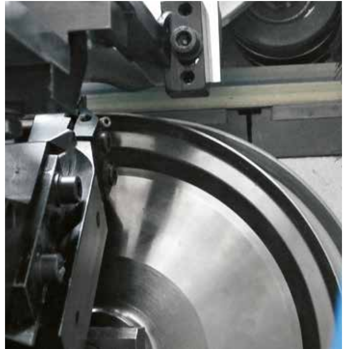
Das "Twin Feeler" Kopiersystem ermöglicht eine konstant hohe Bearbeitungsqualität auch bei hohen Vorschubgeschwindigkeiten.
