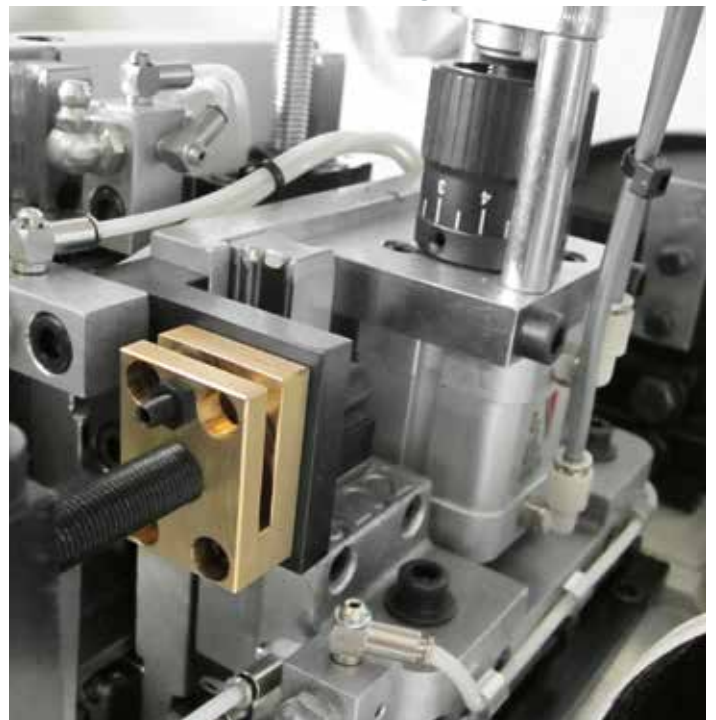
Automatische vertikale Doppelposition für das Fräsen von Plastik- oder Holzkanten (std). Manuelle MikroEinstellung der Taster.
