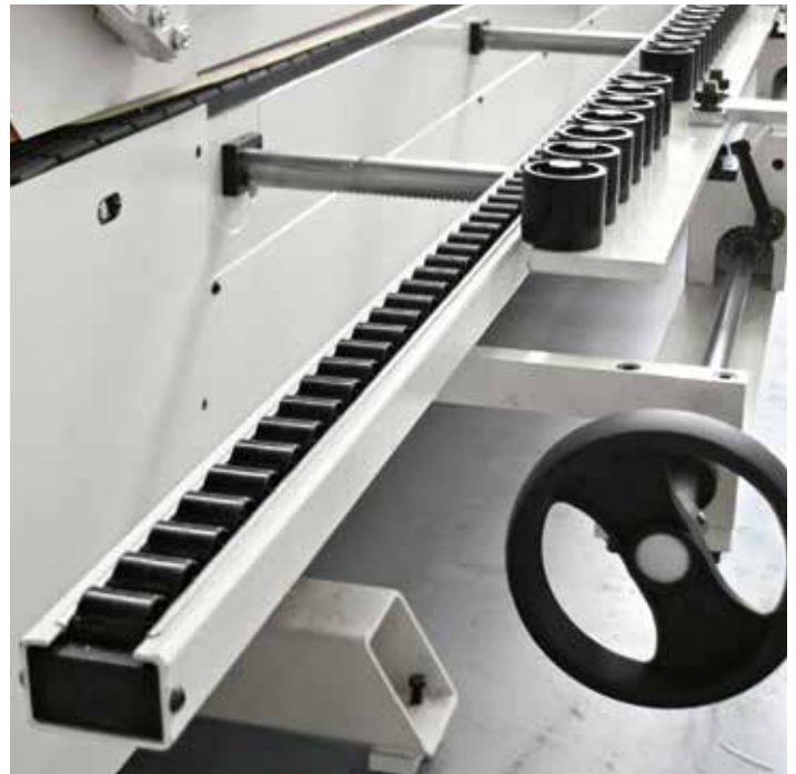
Gegendruckschiene für schmale Platten oder Massivholzleimer (std).
