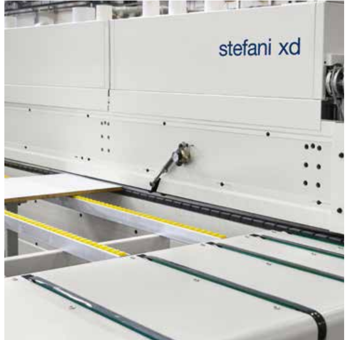
Werkstückausführung zur Anbindung an externe Transporteinrichtungen (opt). Anbindung über mehrfach Ketten mit Auflage (opt).
