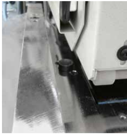
Optimierte Produktivität mit dem Abstandhalter (std), der die genaue Position der eingeführten Platten festlegt.
