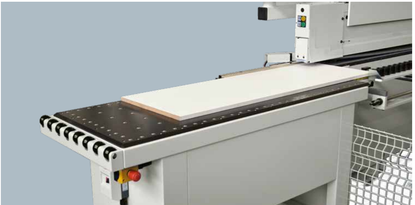
Einfache und schnelle Bewegung der Platten im Ladungsbereich durch den Luftkissentisch (opt).
