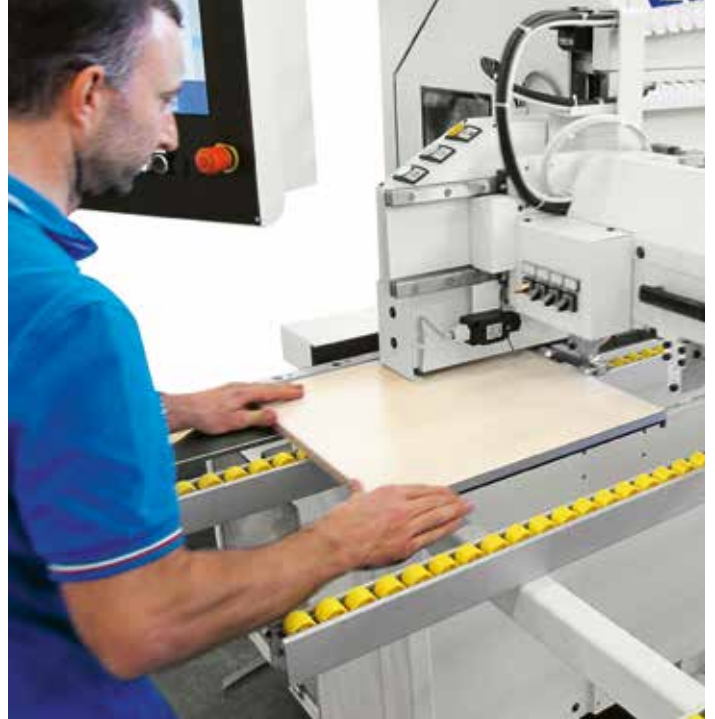
Manuelle Easy Order M Zuführung für die rechtwinklige Einführung der Werkstücke. Max Dimensionen 2,200 mm x 1,200 mm (opt).
