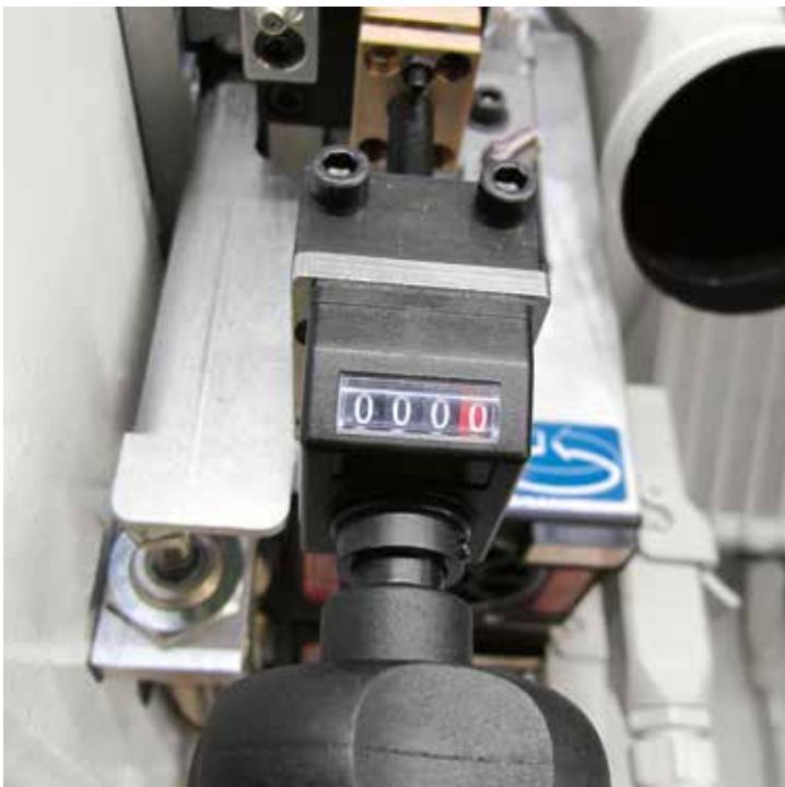
Horizontale Einstellung der Motorposition mit numerischer Digitalanzeige.
