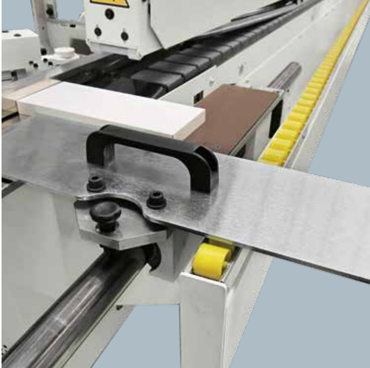
Präzise Zufuhr von schmalen Werkstücken/ Schubladen mit der manuellen Einschubhilfe (opt).
