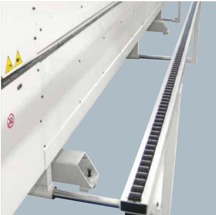
Teleskopauszug, einstellbar von 0 bis 700mm (std).
