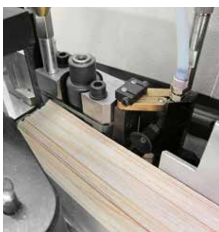
Einzelzuführung für abgelängte Furnier- oder Kunststoffkanten (unicolor, formica, PC).
