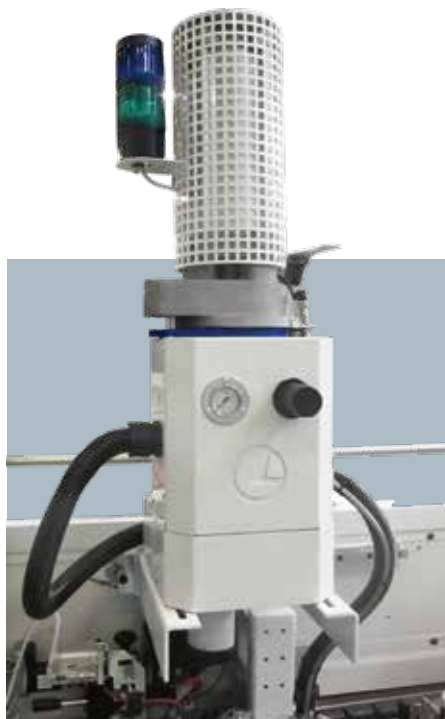
PU BOX L Vorschmelzer Für das Vorsmelzen von bis zu 6 kg/h PU Leim in Patronen- oder Granulatform.
