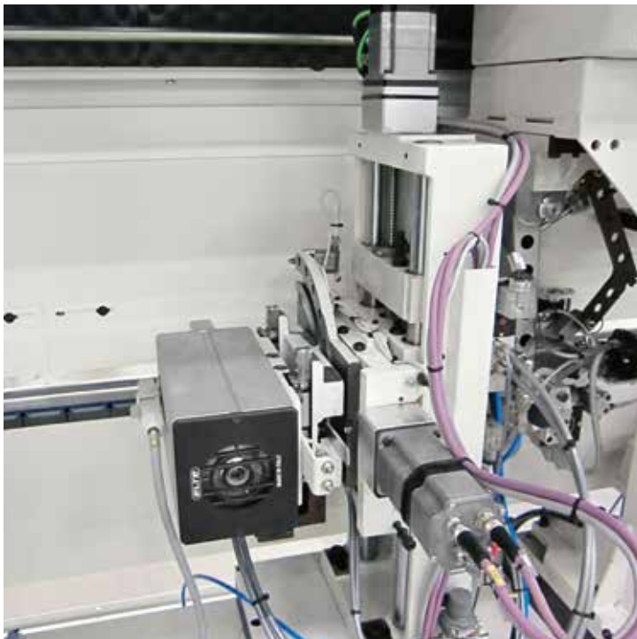
Ausführung mit gesteuerter Profilierposition(Nutposition und Tiefe)
