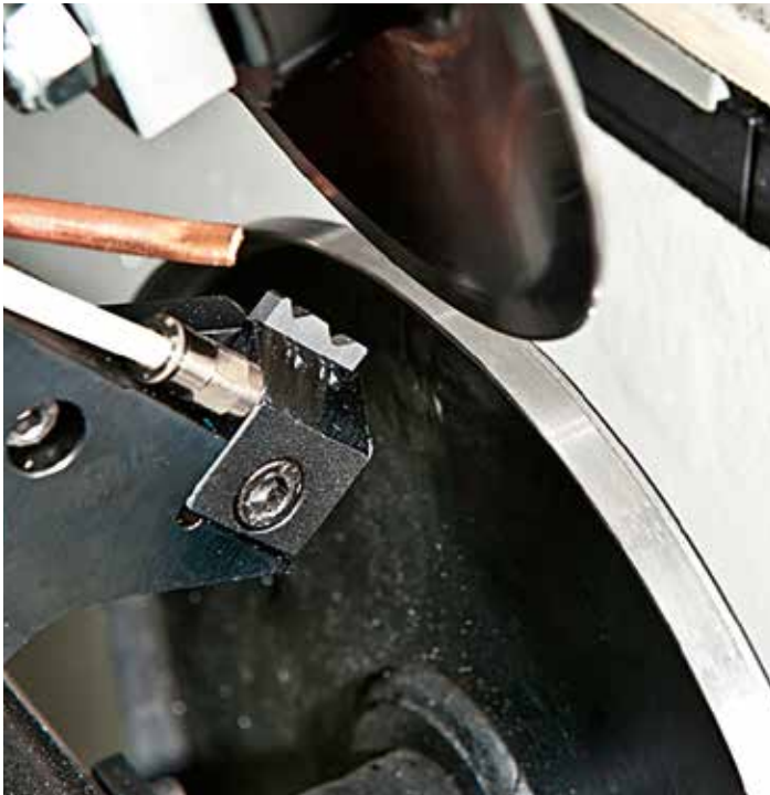
Ausführung für die automatische Bearbeitung von 2 gerundeten Kanten, oder einer gerundeten Kante und einer gefasteten Kante mit 45 Grad (Standard).
