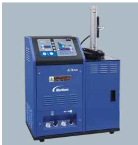
AltaPUR 4 HO EB 60 V (opt) Für das Vorsmelzen von bis zu 6 Kg/h PU Leim in Patronenform. Geeignet für das Leimbecken oder die EB60 Schlitzdüse.
