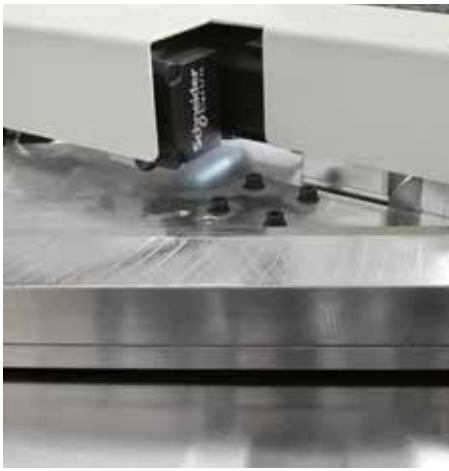
2P Zuführung mit manueller Einstellung (std) Automatische, stufenlose Einstellung über HMI (opt).
