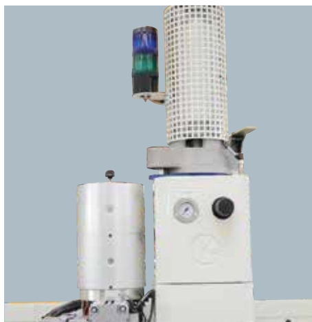
Schneller Leimwechsel, von EVA/PU, durch manuelle Position des Vorschmelzers.
