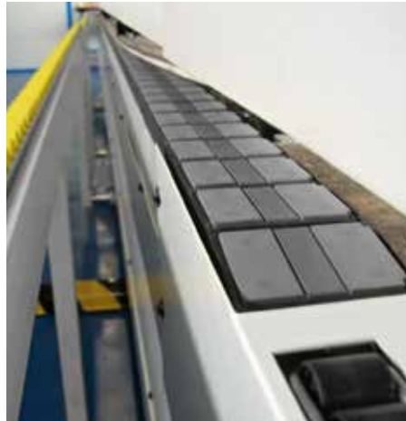
Vorschubkette mit speziellen Gummipplatten für stabilen und sanften Einzug.
