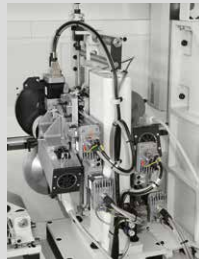
RSU-E Kaum Plattenkontakt dank der Bewegungen auf Kugelumlaufagern. xd
