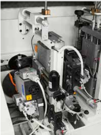
RI/S Automatische Positionierung für 3 verschiedene Radien, beliebige Dünnkanten und 15 mm Massivholzkanten. md
