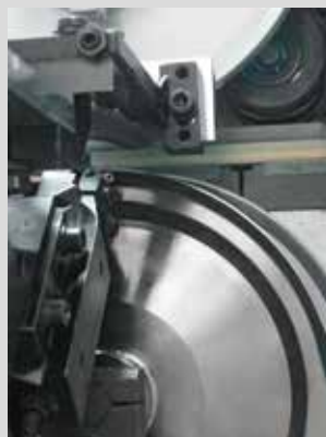
TWINFEELER Kompromisslose Feinbearbeitung durch Tastrolle + versetzte Vortastrolle für hohe Geschwindigkeiten. xd
