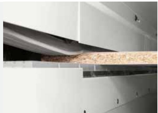
Für Platten mit empfindlichen Beschichtungen geeigneter Riemenandruck.
