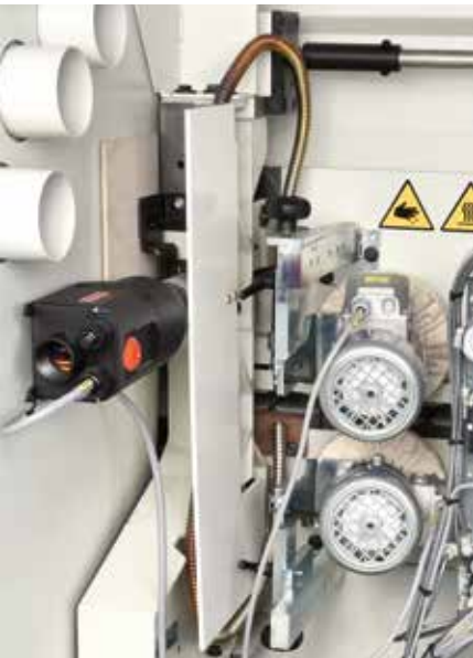
BÜRSTENAGGREGAT SPN Zum Reinigen und Polieren der Kante mit schneller Druckeinstellung und mit Schrägstellung
