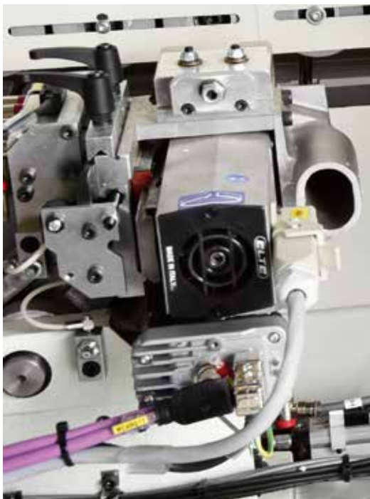
DISPOSITIVO MULTIEDGE ROUND SK Regolazione automatica per la lavorazione di bordi con raggio e sottili
