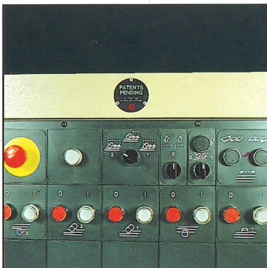
Die vertikale Feineinstellung der oberen Horizontalspindeln über Schalterpult macht den Wechsel der Arbeitshöhe noch schneller und präziser.
