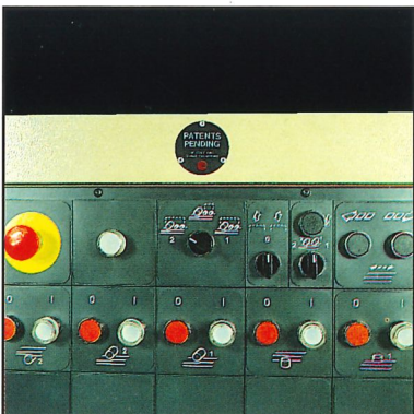
Die vertikale Feineinstellung der oberen Horizontalspindeln über Schaltpult macht den Wechsel der Arbeitshöhe noch schneller und präziser.
