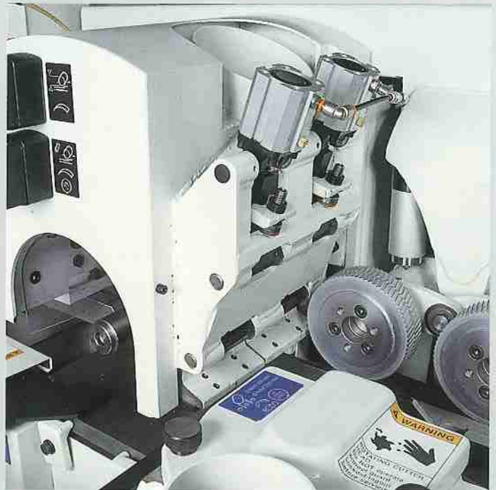
Sabots presseurs placés devant l'arbre horizontal supérieur, avec mouvement incliné et pression pneumatique
