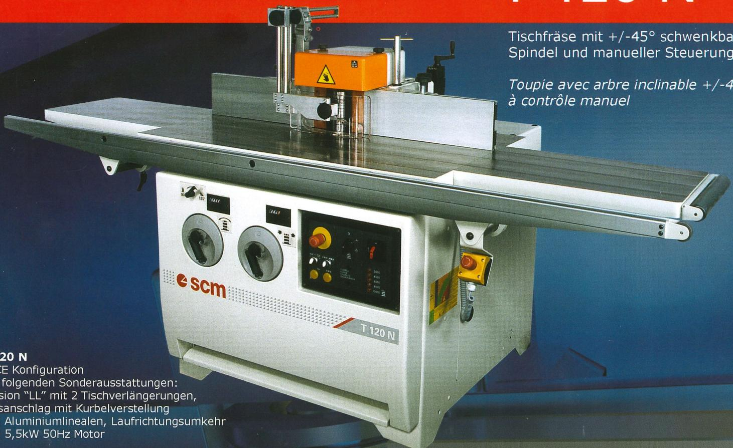
Tischfräse mit +/-45° schwenkbarer Spindel und manueller Steuerung
