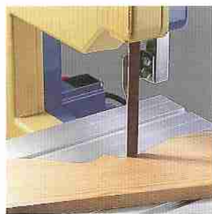
Der bis zu 45 Grad schwenkbare Tisch erlaubt auch komplizierte Schnitte.
