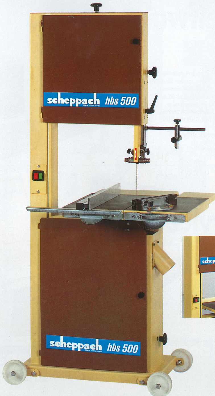
scheppach hbs 500: massiver, plangeschliffener Grauguß- tisch und 3-Rollen-Präzisions- führung, oben und unten
