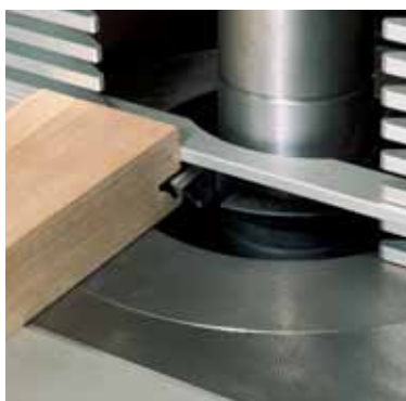
Variabel integrierbarer Multifunktionsanschlag überbrückt die Werkzeuglücke – zum sicheren Arbeiten auch mit schmalen Werkstücken.
