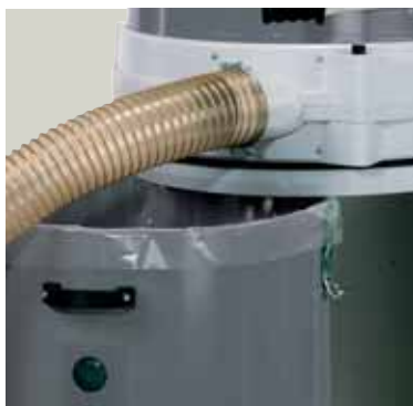
Bequemer und schneller Spänesackwechsel durch einfaches Herausnehmen des fahrbaren Behälters.
