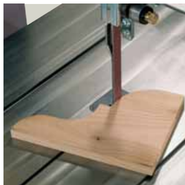
Bandschleif-Einrichtung zum rationellen Schleifen von Konturen.
