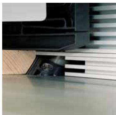
Spindel bis 45^\circ nach hinten schwenkbar – erlaubt sicheres Arbeiten mit verdecktem Werkzeug und die Positionierung von Andrückvorrichtung und Vorschubapparat nahe am Werkzeug.
