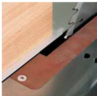
Strapazierfähige Pertinax-Tischeinlage, plan-genau mit dem Gusstisch.
