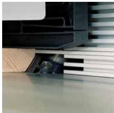
Spindel bis 45° nach hinten schwenkbar – erlaubt sicheres Arbeiten mit verdecktem Werkzeug und die Positionierung von Andrückvorrichtung und Vorschubapparat nahe am Werkzeug.
