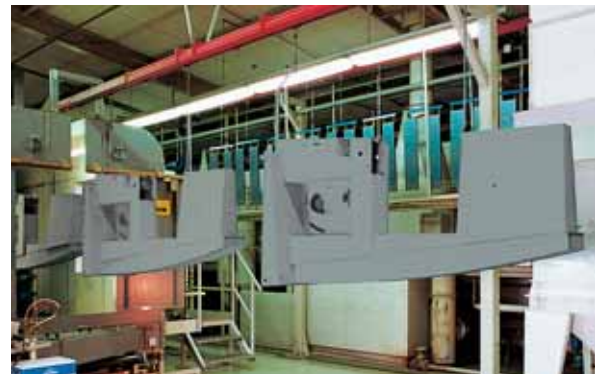
Die Beschichtungsanlage mit 12 Düsen und sparsamem Pulververbrauch liefert beste Qualität – damit Sie mit Ihrer scheppach professional lange gut aussehen.
