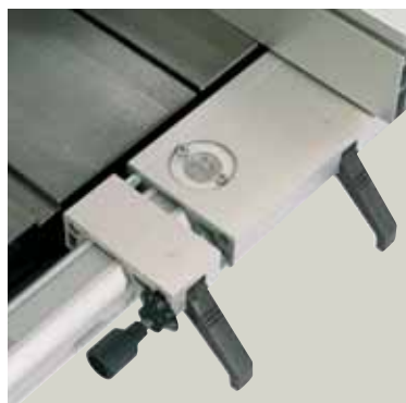
Millimetergenau einstellbarer, stabiler Längsansschlag mit Lupe zur Feineinstellung (optional)
