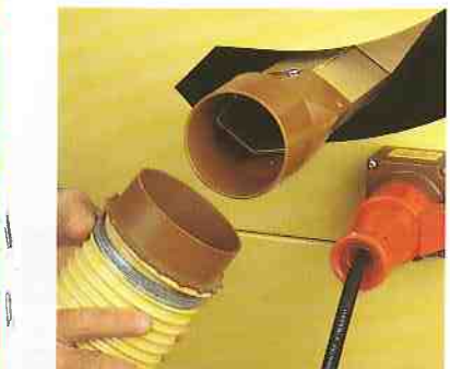
Anschlußstutzen für scheppach Absauganlage.
