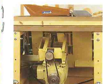
Sägeblatt-Antrieb über Hochleistungs-Keilriemen
