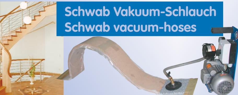
Einweg-Vakuumsäcke aus hochfestem Polyethylen. Sie eignen sich für Formverleimungen z.B. von Treppenwangen, Handläufen etc. Die benötigte Schlauchlänge wird von der Rolle abgeschnitten. Durch Klebeband werden die Enden verschlossen, nachdem Werkstück und Absaugvlies eingebracht wurden. Die Vakuumeinführung erfolgt mithilfe eines Saugtellers durch einen Einschnitt in der Folie.
