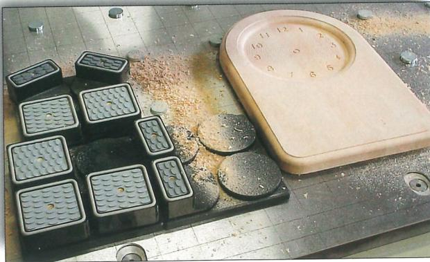
Mit den Vakuum-Aufspannsystemen **INNOSPANN** kann jedes CNC-Bearbeitungszentrum einfach und schnell nachgerüstet werden. Das modulare Baukastensystem sorgt dabei für maximale Flexibilität. Vier Grundsysteme mit verschiedenen Kombinationsmöglichkeiten stehen zur Verfügung.
