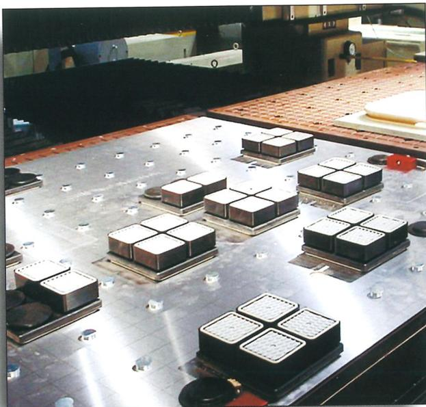
Auf der Steel-Plate können sowohl Quad Base (siehe S. 8) als auch Mono Base (siehe S. 9) frei positioniert werden. Als Orientierungshilfe bei der Positionierung besitzt die Steel-Plate eine gelaserte Rastereinteilung. Nicht bedeckte Vakuum-Öffnungen müssen mit Hilfe von Verschluss-Magneten abgedichtet werden. Diese sind als Zubehör separat mitzubestellen.
