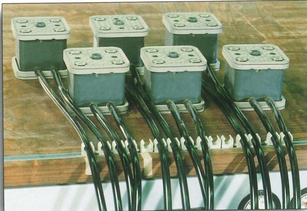
Das bewährte Vakuum-Aufspannsystem VC-G **mit Schlauchanschluss** ist universell auf allen CNC-Bearbeitungsmaschinen mit glatten Tischen einsetzbar. Garantiert beschädigungsfreies Spannen, höchste Präzision und maximale Haltekraft.
