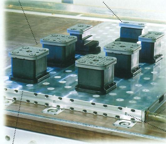
■ **Der Aufspanntisch wird nach der Montage überfräst, um eine absolute Genauigkeit zur Werkzeugspindel zu gewährleisten. Daraus resultiert maximale Präzision bei der Bearbeitung.**
