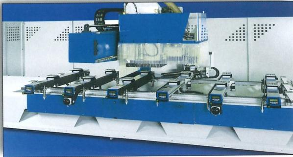
Das Vakuum-Aufspannsystem VC-K1 für CNC-Bearbeitungsmaschinen mit **1-Kreis-System**. Die Blocksauger werden mit mechanischer Klemmung auf den Konsolen vorfixiert, um sie gegen das Verschieben beim Werkstückhandling zu sichern. Durch Vakuum werden Werkstück und Blocksauger sicher und präzise auf die Konsolen gespannt.
