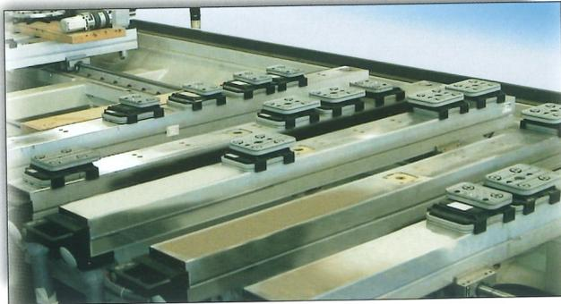
Das Vakuum-Aufspannsystem VC-K2 für CNC-Bearbeitungsmaschinen mit **2-Kreis-System**. Die Blocksauger mit **Höhe  $H = 50$  mm** werden mittels Vakuum auf den Konsolen vorfixiert, um sie gegen das Verschieben beim Werkstückhandling zu sichern. Über den zweiten Vakuumkreis werden Werkstück und Blocksauger sicher und präzise auf die Konsolen gespannt.
