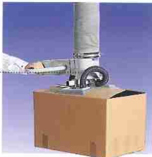
JUMBOERGO mit Doppelgreifer für verklebte, unreifte oder unverschlossene Faltkartons.
