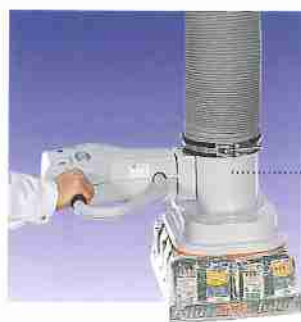
JUMBOERGO mit Sackgreifer für Trays.
