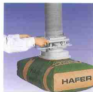
JUMBOSPRINT mit Sackgreifer für Kunststoff- und Papiersäcke.
