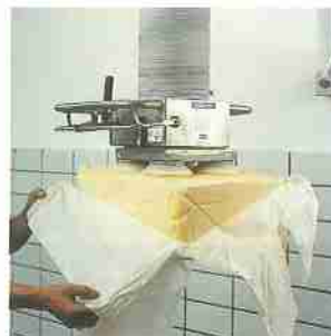
JUMBO SPRINT aus Edelstahl mit Butter-/Käsegreifer
