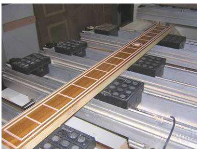
Rasterplatten (oberes Bild) mit eingefrästen Vakuum Kanälen und Bohrungen für Anschlagzylinder falls erforderlich.
