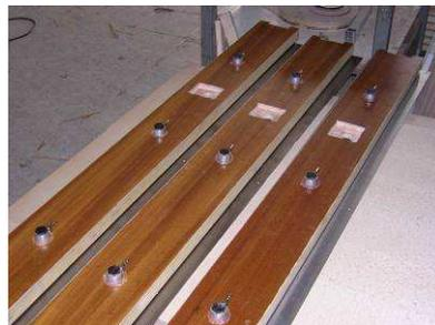
Unterböden der Rasterplatten (Bild) mit Schlauchverbindungen für die Vakuumversorgung.
