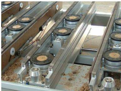
Das Vakuum-Aufspannsystem Innospann ist zum Nachrüsten von jedem Konsolen-System aller CNC Maschinenhersteller geeignet
