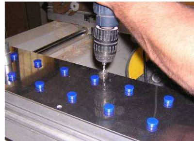
Die Steel-Plates werden oben auf den Rasterplatten mit Hilfe von Schrauben befestigt.
