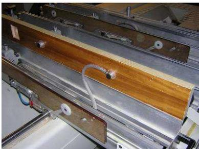
Die Vakuumversorgung für die Rasterplatten wird mit Schlauchanschlüssen und Vakuumschläuchen sichergestellt.
