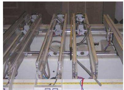
Fertige Profile mit ausgebauten Blocksaugern für die Aufrüstung.
