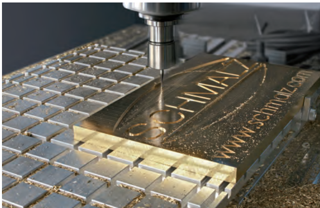
Vakuum-Aufspannsystem Matrixplatte beim Gravieren eines Messingschildes
