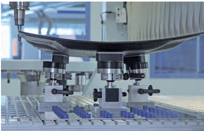
Basic Holding Fixture BHF bei der Bearbeitung eines CFK-Bauteils
