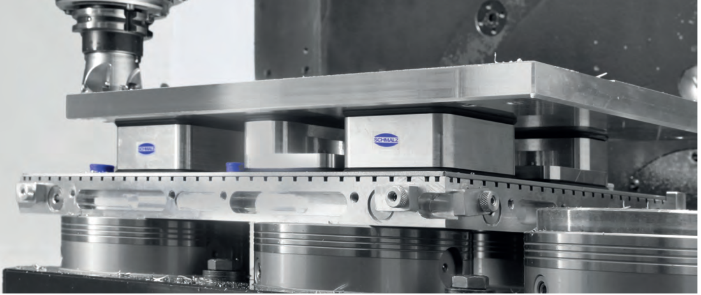
Vakuum-Aufspannsystem Matrixplatte mit Innospann Steel-Plate und Blocksaugern zur Fertigung von Durchbrüchen in der Fünf-Achs-Bearbeitung
