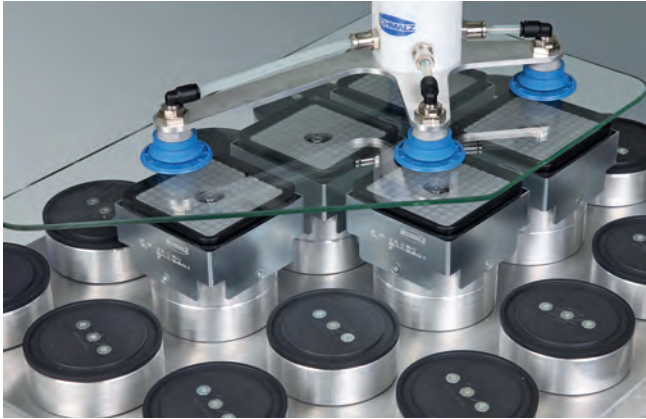
Schmalz Schnellrüstsystem SQC beim Spannen von Glasbauteilen auf einem CNC-Bearbeitungszentrum von Bystronic
