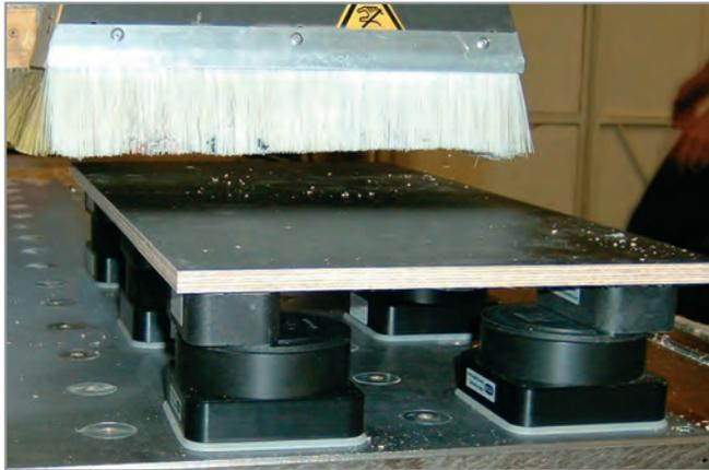
Innospann Steel-Plate-T mit Mono-Bases und Sauger-Cups
