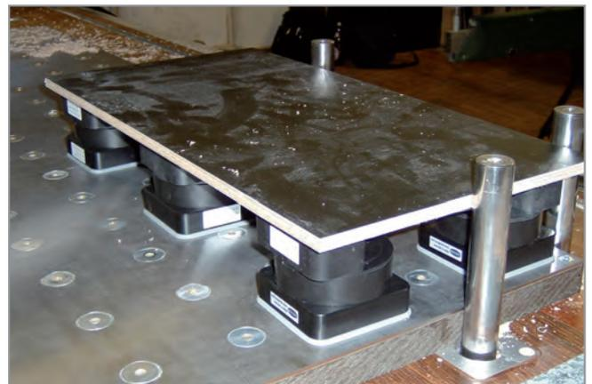
**Innospann Steel-Plate-T** | Umrüstung Glatttisch durch Steel-Plate-T mit Mono-Bases und diversen Sauger-Cups, Montage auf Raster-Zwischenplatte
