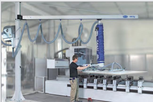
Komplettes Handhabungssystem mit Vakuum-Schlauchheber und Kran
