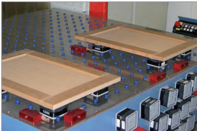
Innospann Steel-Plate mit Mono-Bases und Sauger-Cups
