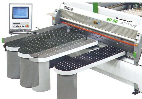
Déplacement des plans de décharge pour faciliter le mouvement des panneaux.
