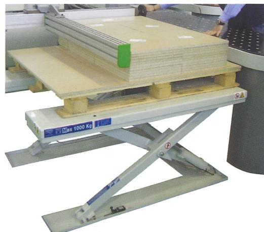
Table hydraulique pour l'empilage sur palette du matériel usiné par la scie à débit. La table a une butée de référence réglable manuellement qui s'escamote pour faciliter l'élimination de la palette.
