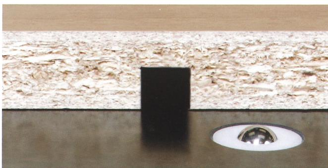
Système d'exécution automatique de rainures avec programmation de la largeur par contrôle numérique. La profondeur des rainures peut être réglée manuellement ou par un dispositif électronique depuis l'extérieur de la machine.
