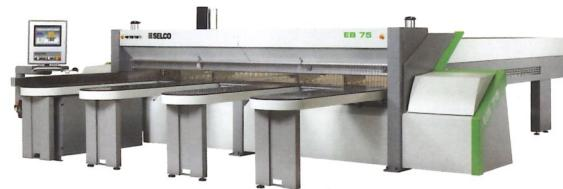
Die Steuerung OSI (Open Selco Interface) garantiert die komplette automatische Ausführung von komplexen Schnittbildern, bei gleichzeitiger Optimierung der Bewegungen des Plattsenschiebers, Sägewagens und der Winkelanpressvorrichtung. Die vollautomatische Kontrolle des Sägeblattüberstandes und der Vorschubgeschwindigkeit, in Abhängigkeit der Pakethöhe und der Größe der Besäumung, ergeben ein optimales Schnittergebnis.
