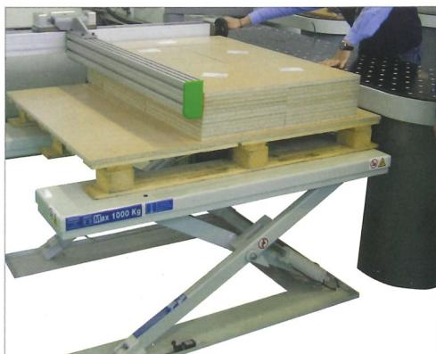
**Hydraulische Abstapelhebebühne** zum Ablegen des geschnittenen Materials auf Paletten. Die Abstapelhebebühne hat einen manuellen einstellbaren Referenzanschlag, der aufgeklappt werden kann, um die Entfernung das Entladen der Palette zu erleichtern.
