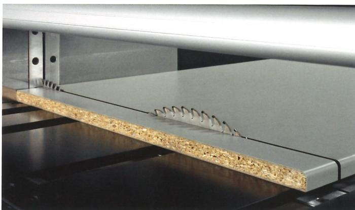
Postforming – Vorrtsäge PFS zur Queraufteilung von Soft- oder Postformingsträngen. Die aufsteigende Vorrtsereinheit wird über das Programm der Eintritt und Austritt an den Strängen gesteuert, so dass die Kanten nicht ausbrechen.
