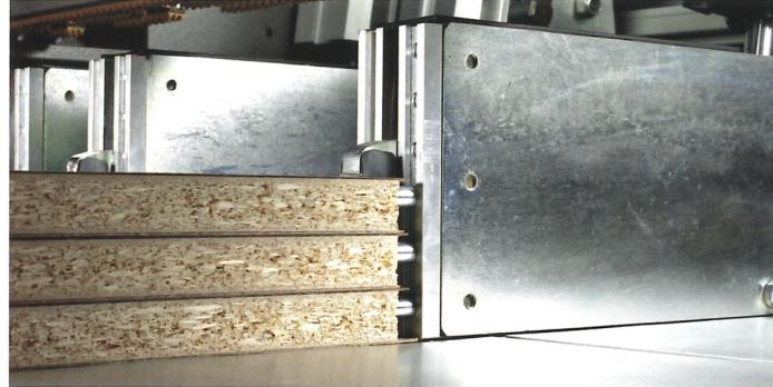
**Anschlüsse für die Besäumung von Platten mit überstehenden Belägen (Funieranschläge), auch im Paket möglich.** Zur Verfügung steht auch eine Software zum Formatieren der Teile.
