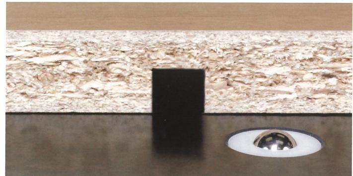
Nuteinrichtung, wobei die Nutbreite über die Steuerung programmiert wird. Mit manueller oder elektronischer Tiefeneinstellung.
