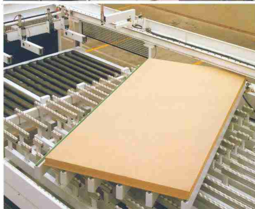
Stazione rotante per l'esecuzione del pretaglio Drehvorrichtung für Kopfschnitte
