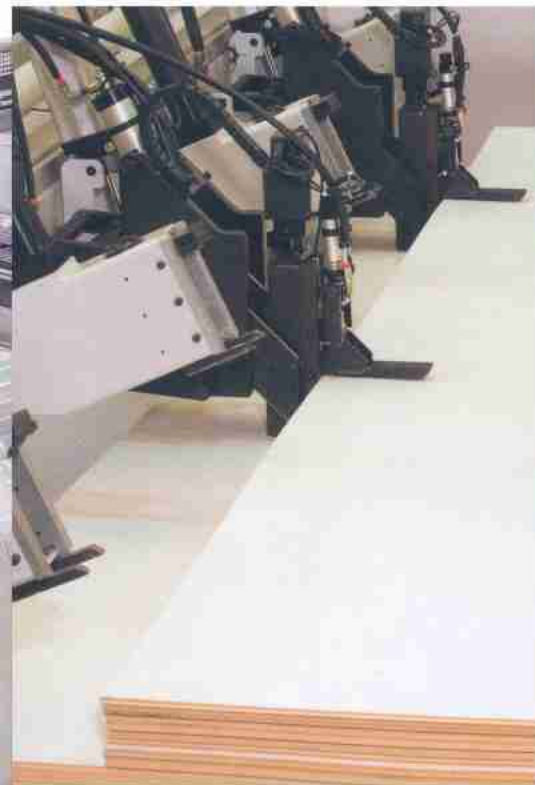
Dispositivo per carico dei pannelli sottili Vorrichtung zur Beschickung von dünnen Platten
