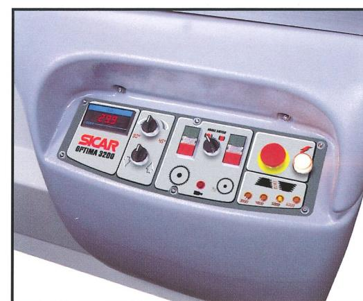
Il quadro elettrico della Optimal racchiude pulsante di avviamento della lama principale con stella triangolo automatico. Il sollevamento e l'inclinazione elettrica della lama forniti di attuatore meccanico a stelo coperto offrendo grande protezione dalla polvere.
