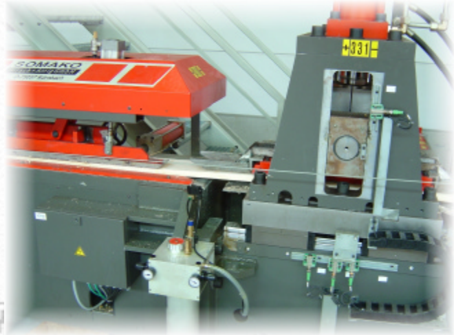
Spezialpresse für Endloslängen Preßkraft bis max. 20 to
