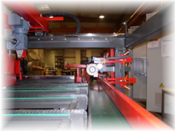
Übergabestation zur sicheren Vereinzelung der Holzpakete durch Pakethaltevorrichtung. Geeignet für Vertikal- und Horizontalverzinkung
