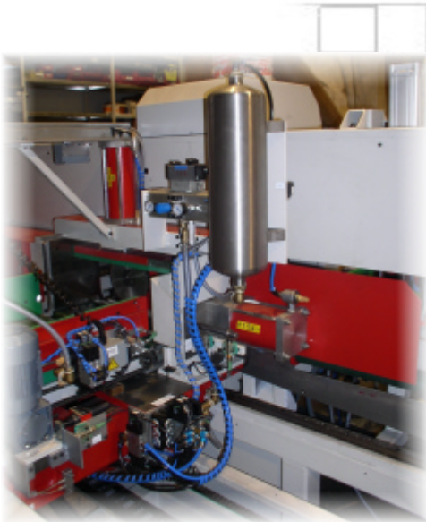
Keilzinkenfräse mit 620 mm Tischbreite
