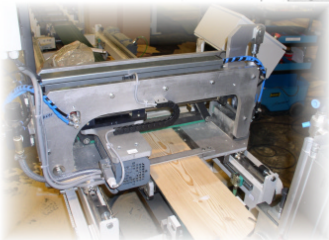
Mitlaufende Ablängsäge zum Kappen der Endlänge
