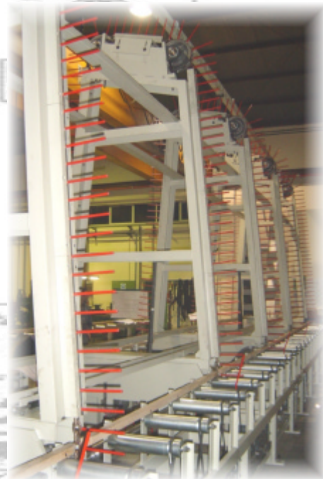
Paternoster als Aushärtelager für die verleimten Teile
