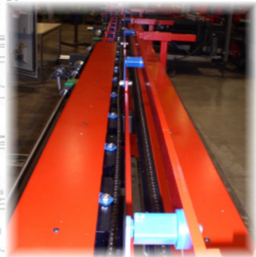
Lange Ketteneinfädelstrecke zur passgenauen Voreinfädelung der Zinken. Mit Niederhalter von oben
