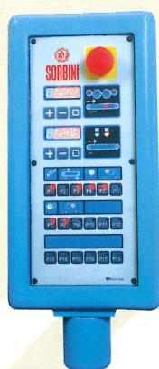
Quadro elettrico di comando standard con indicazione digitale delle funzioni e
