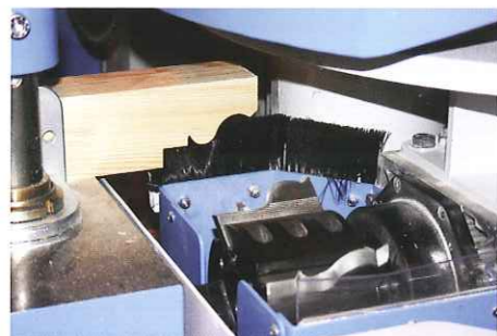
Horizontální frézovací jednotka pro konce křídel posuvných oken - přísl. pro verzi E Horizontal milling unit for heritage sash horn detail - E series optional
