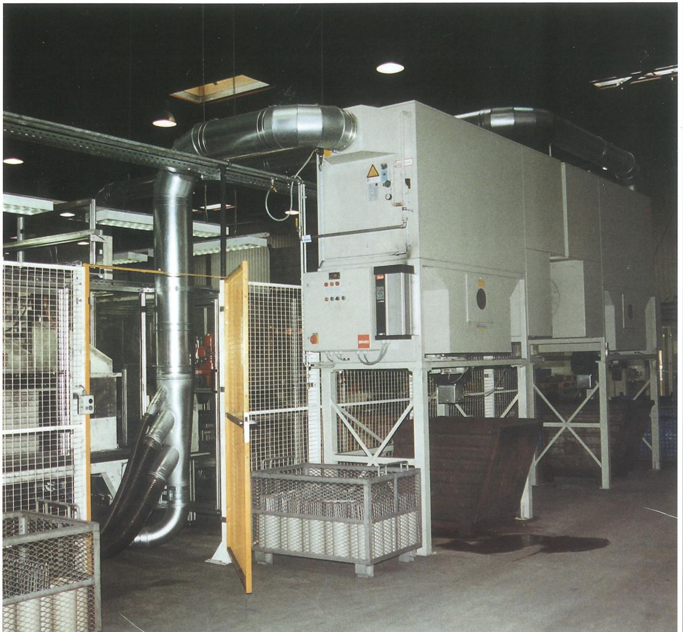
Das **SPÄNEX - Entsorgungssystem** bietet Ihnen die Komplettlösung von der Erfassung an der Maschine, dem pneumatischen Transport mit der anschließenden Abscheidung in der Filteranlage und, wenn die Möglichkeit besteht, der Brikettierung.
