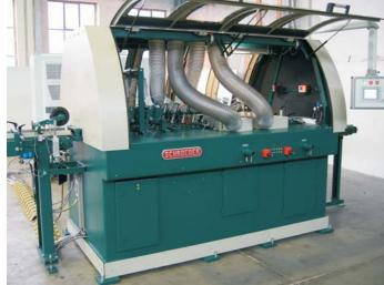
Dünnschnittsägen mit Schnittbreite bis zu 0,8 mm (Ritzen) und 1,10 mm (Spalten).
