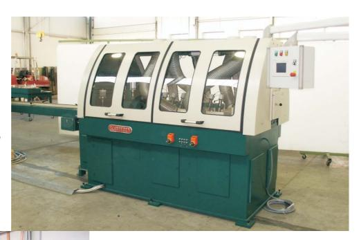
4 Walzen Vorschub mit pneumatischer Steuerung und automatischer Geschwindigkeitsregelung. Pneumatische obere Druckrollen und Seitenführungen, optimierte Spaltkeile sowie permanentes Sägen-Kühl-System.
