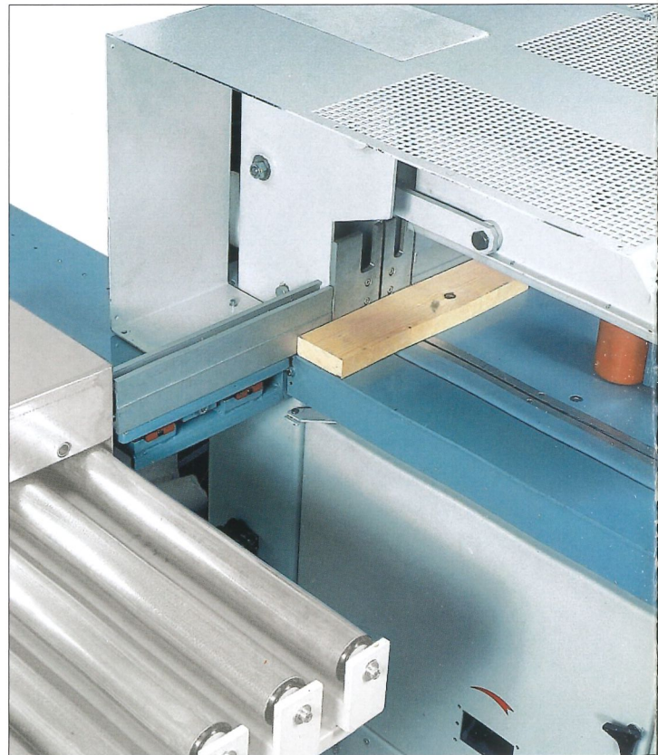
Trappe pour l'évacuation des résidus ou des déchets (ouverte) Trampa de expulsión recortes y desperdicio (abierta)
