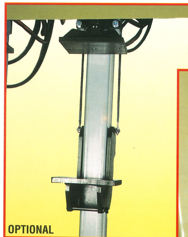
Carico e scarico frontale del materiale. Pressori idraulici in posizione di parcheggio laterale. Chargement et déchargement frontal du matériel. Presseurs hydrauliques frontaux en position de parking latéral. Laden-Abladen des Materials. Hydr. Front-Druckvorrichtungen in Parkposition. Loading and unloading of the material at the front. Hydraulic front clamps positioned on side parking stations. Carga y descarga frontal del material. Prensos hidráulicos frontales en posición de aparcamiento lateral.
