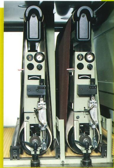
Star 2R. Calibratrice levigatrice a due nastri con due rulli ø 220 mm azionati da un unico motore da 15 Kw.
