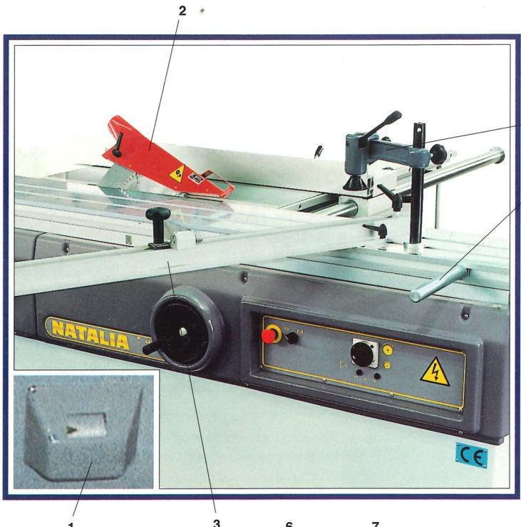
**A** Natalia è dotata di un indicatore dell'inclinazione della lama ("1") posto sul pannello frontale. Il protettore ("2") della lama è montato sul coltello divisore. La dotazione della macchina può essere completata, a richiesta, da una riga per tagli angolati ("3"), un premilegno ad eccentrico ("4"), un'impugnatura ("5") per agevolare la movimentazione del carro.
