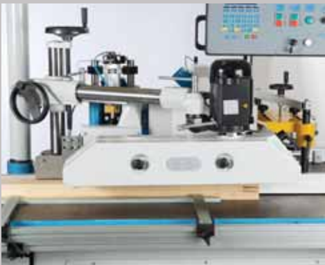
Profilatura interna degli elementi della finestra
