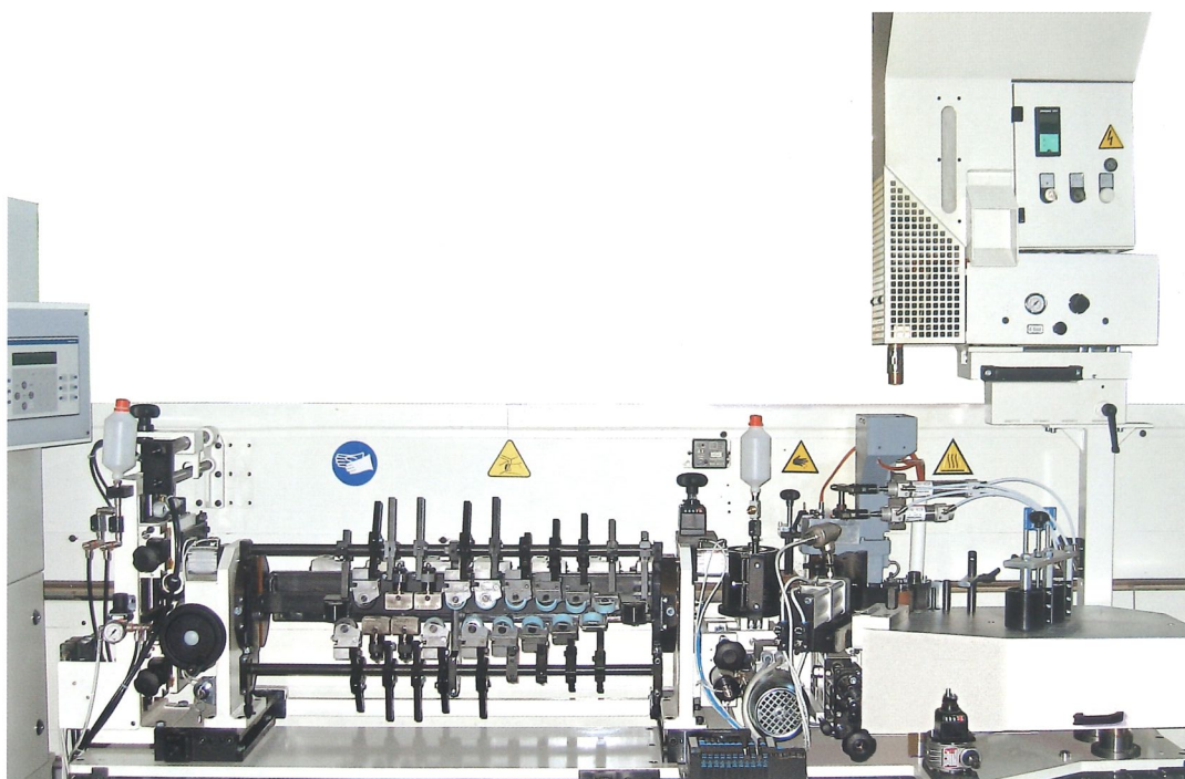
Softforming gluing unit Groupe encolleur softforming Softforming Aufleimaggregat
