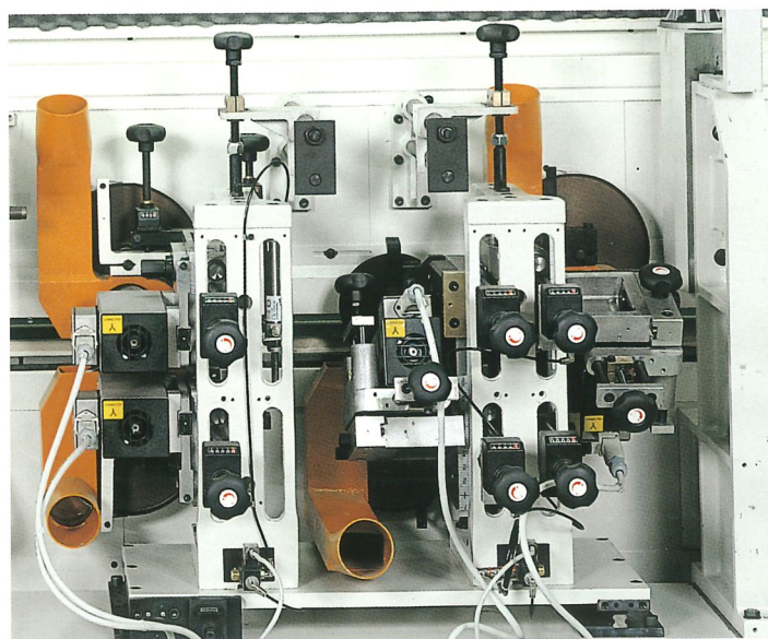
Fine trimming unit Groupe d'affleurage de définition Fase- und Radiusfräsaggregat
