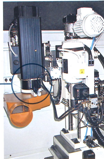
Grooving unit with HSK quick release device Groupe toupie avec déclenchement rapide outil HSK Fräsaggregat mit Werkzeugschnelllösung HSK
