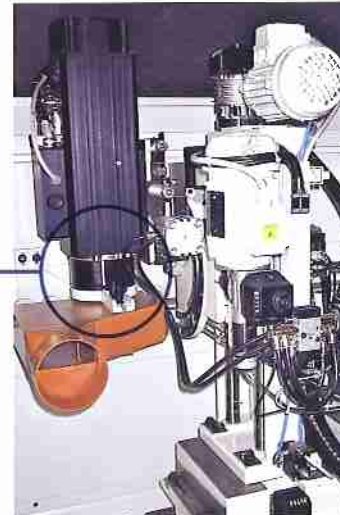
Gruppo toupie con sgancio rapido dell'utensile HSK Grooving unit with HSK quick release device Grupo toupie con desenganche rápido de la herramienta HSK
