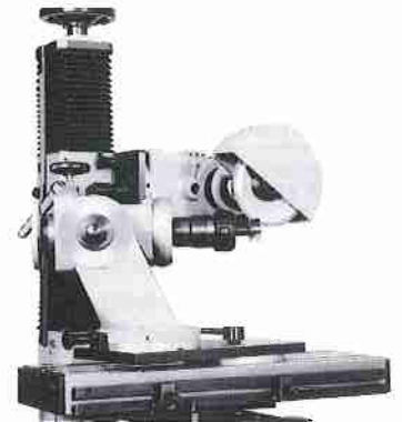
Schleifen von Zylinderkopfbohrern Grinding of cylinder drills Affûtage de mèches
