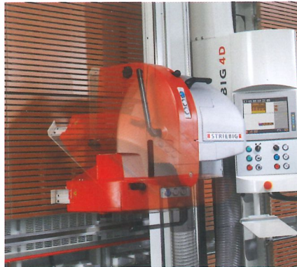
Eine der zahlreichen Funktionen der Striebig 4D: die automatische Motorschwenkung. Sie unterstützt den vollautomatischen Sägeablauf und erleichtert dem Bediener die Arbeit enorm.
