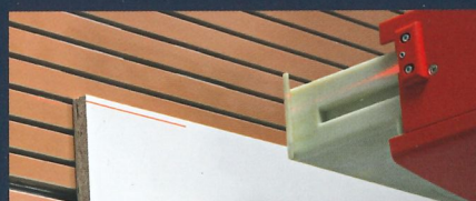
Laser gestützte Anzeige des horizontalen Schnittes (serienmässig)
