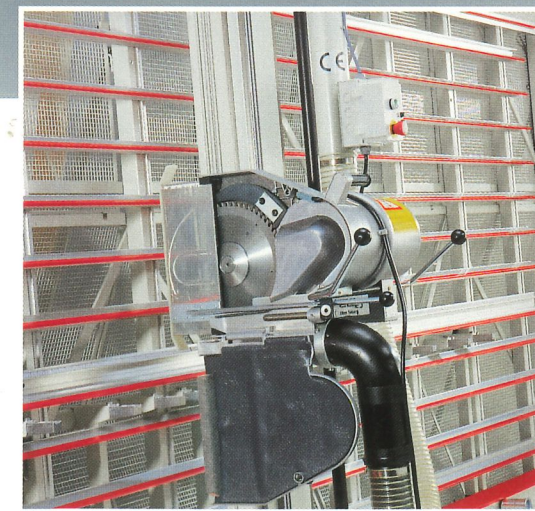
ECONOM IIA: Barre de sciage avec carter de la scie ouvert
