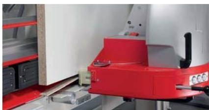
L'option 4SB pour le délignage inférieur facilite énormément le travail. Les panneaux sont bloqués par des ventouses, aucune intervention physiquement pénible n'est plus nécessaire. Le système 4SB effectue automatiquement les coupes de délignage inférieures sur des panneaux d'une longueur de jusqu'à 5300mm et d'une hauteur de jusqu'à 2185mm.
