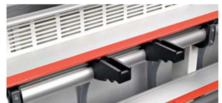
Les taquets high tech en matière synthétique renforcée par fibres offrent une protection spéciale même pour les matières présentant un chant, et les chants postforming.
