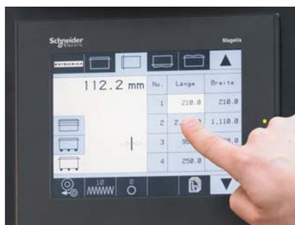
Saisir les cotes, terminé. Système de positionnement électronique l'EPS.x est entièrement intégré au tableau de l'écran tactile. Il permet le positionnement simple à 1/10mm près de l'axe de coupe horizontal.
