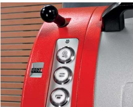
Une manette de réglage robuste permet de régler en continu la butée de profondeur (jusqu'à 25 mm).
