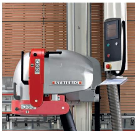
Le pivotement automatique du moteur est l'une des nombreuses fonctions de l'EVOLUTION qui assistent le sciage manuel.
