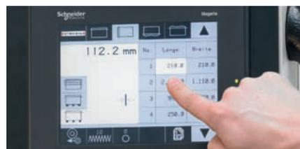
Saisir les cotes, terminé. Le système de positionnement électronique EPS.x est entièrement intégré au tableau à l'écran tactile. Il permet le positionnement simple à 1/10mm près de l'axe de coupe horizontal.
