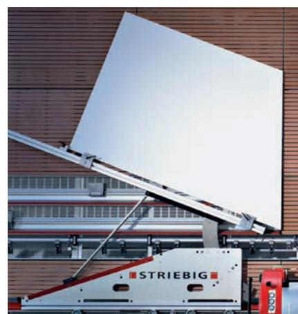
Le dispositif pour coupes d'angles WSG peut être utilisé à gauche ou à droite de chaque point de coupe vertical. Son montage est facile et rapide. Domaine d'utilisation : panneaux d'une épaisseur maximale de 42 mm, angles et onglets précis de 0° - 46°.
