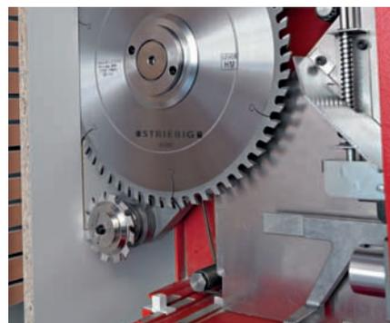
Vous économisez du temps, des frais et des outils – les avantages du dispositif inciseur VSA. Pour les grandes quantités et un niveau de qualité peu élevé des panneaux, le dispositif VSA est un must. Parce qu'il multiplie la durée de service des lames de scies principales par 7 ou 8. Une inciseuse dure plus longtemps que 3 lames de scies principales au moins.
