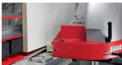
L'option 4SB pour le délignage inférieur facilite énormément le travail. Les panneaux sont bloqués par des ventouses, aucune intervention physiquement pénible n'est plus nécessaire. Le système 4SB effectue automatiquement les coupes de délignage inférieures sur des panneaux d'une longueur allant jusqu'à 5300mm et d'une hauteur allant jusqu'à 2185mm.
