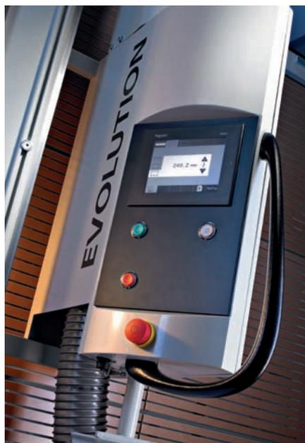
Le guidage de l'utilisateur et la détection des dysfonctionnements sont disponibles en plusieurs langues. Des symboles clairs guident l'utilisateur à travers les menus. Seules les fonctions exécutables avec la scie s'affichent. Les erreurs de commande sont ainsi quasiment exclues. Le compteur d'heures de service de série permet de déterminer le temps de fonctionnement de la scie.
