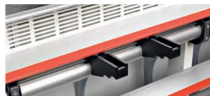
Les taquets high tech en matière synthétique renforcée par fibres offrent une protection spéciale pour les matériaux à chants particulièrement sensibles, et les chants postforming.
