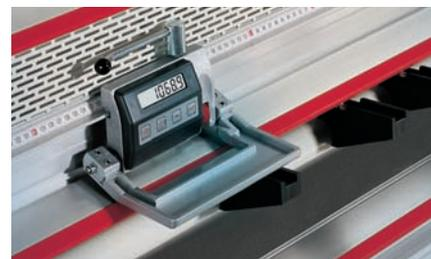
Système de mesurage numérique DMS pour les deux axes (de série). Précision d'affichage librement sélectionnable entre 1,0/0,5 et 0,1mm.
