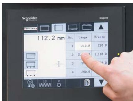
Digitare le quote, finito. L'EPS, sistema di posizionamento elettronico, e completamente integrato nel Touch-Screen-Panel. Permette il semplice posizionamento con precisione di 1/10mm degli assi di taglio orizzontali x-assi.
