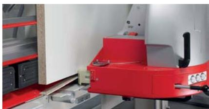
L'opzione 4SB per il taglio di rifilatura inferiore costituisce una facilitazione enorme del lavoro. I pannelli vengono bloccati con sicurezza mediante ventose, il gravoso lavoro fisico non è più necessario. Pannelli fino ad una lunghezza di 5300mm ed un'altezza di 2185mm vengono rifilati automaticamente in basso dal sistema 4SB.
