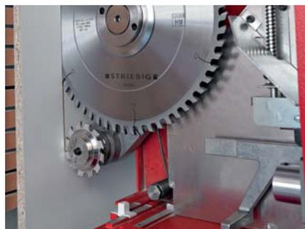
Risparmio di tempo, denaro e utensili - i vantaggi dell'aggregato di preintagliatura VSA. Con maggiori quantità di pannelli e un livello qualitativo ev. inferiore, l'impiego del VSA è un "obbligo". Perché: la durata utile di una lama principale aumenta di 7-8 volte. Una lama di preintagliatura supera la durata utile di almeno 3 lame principali.
