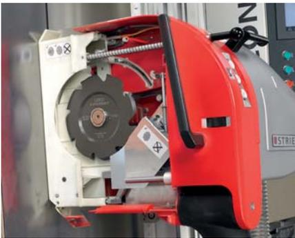
Molti incarichi richiedono lavori di scanalatura e di fresatura. Con un'EVOLUTION questi possono essere eseguiti senza problemi. Si possono fresare e scanalare materiali legnosi e pannelli compositi.
