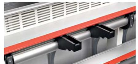
Reticolo "high-end" in materiale sintetico rinforzato con fibre offre una protezione speciale per i materiali dei bordi particolarmente sensibili e i bordi post-forming.
