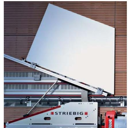
Il dispositivo per tagli angolari WSG si impiega a sinistra ed a destra accanto ad ogni punto di taglio verticale. Si monta con semplicità ed a rapidamente. Campo d'impiego: Pannelli spessi fino a 42mm, angoli esatti e tagli obliqui da 0° a 46°.
