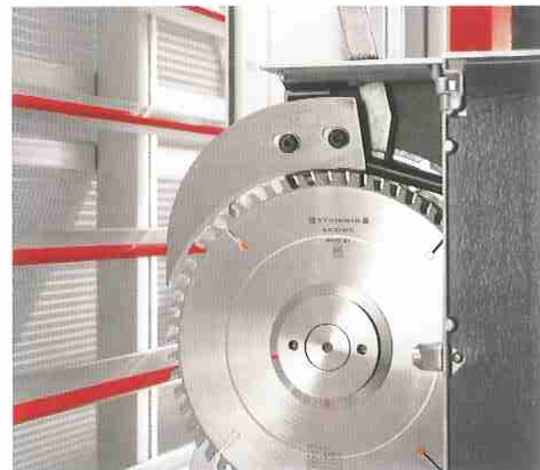
Neue Technik für mehr Sicherheit. Der Spaltkeil schwenkt auch bei laufendem Motor ein und aus. Die Rückstellung erfolgt automatisch.
