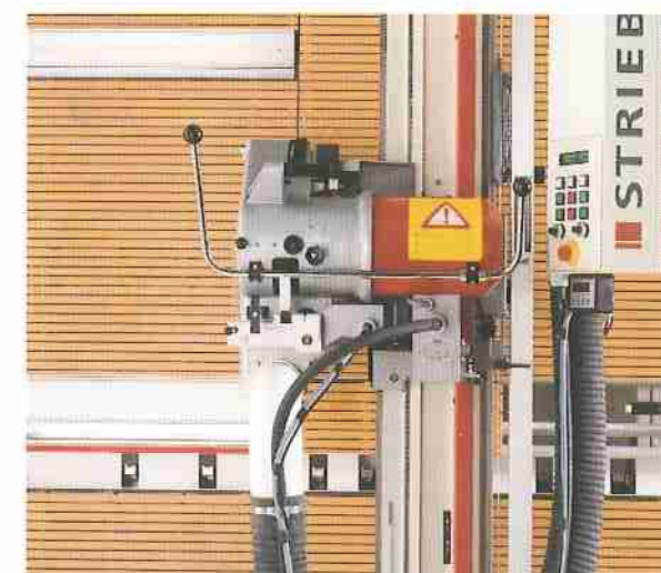
Die neue Drehstange der dritten Generation, mit den Rasterstellungen neutral, Vertikalschnitt und Horizontalschnitt.
