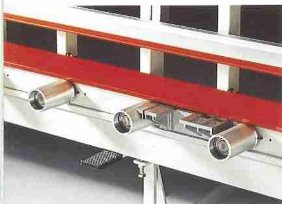
Ménagent les chants: les rouleaux d'appui montés sur roulements à billes, placés en grand nombre dans la zone de coupe principale.
