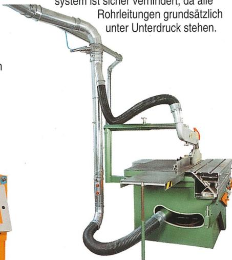
Absaugstrang mit einem, dem Abzweig nachgeordneten, systemgesteuerten, pneumatischen Absperrschieber.
