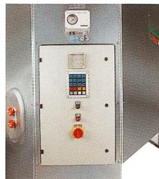
Die Anlagensteuerung ist fest eingebaut, dadurch geringer, bauseitiger Verdrahtungsaufwand.
