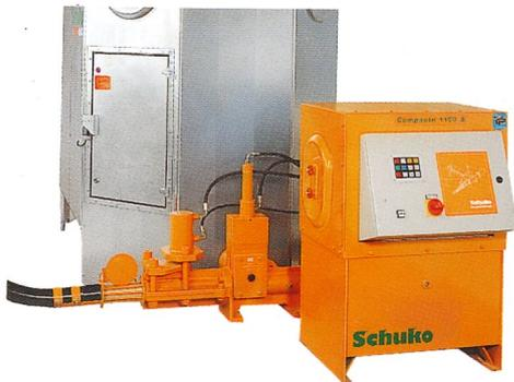
Nachgeschaltete Brikettierpresse Compacto 1100 S, zur staubfreien Entsorgung nach TRGS 553. Wird die Revisionstür geöffnet, ist automatisch die ganze Anlage elektrisch allpolig abgeschaltet.
