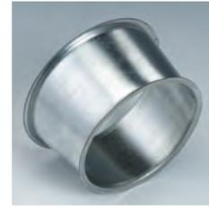
→ **Übergangsstücke** helfen, den größeren Durchmesser auf einen kleineren zu reduzieren. Es ist sinnvoll, den großen Durchmesser möglichst lange beizubehalten. Je größer der Durchmesser, um so geringer ist der Reibungswiderstand und somit der Saugverlust [Pa].
