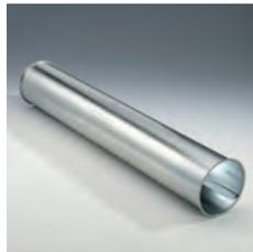
→ **Rohre** von Schuko sind aus sendzimirverzinktem Stahlblech mit einer Baulänge von ca. 1.000 mm, die Längsnaht ist gefalzt. Wie bei allen Bauteilen von Schuko ist an beiden Enden eine Bördelung zur einfachen Weiterverbindung mit anderen Teilen mittels Rohrschellen bzw. Flanschringen vorhanden.
