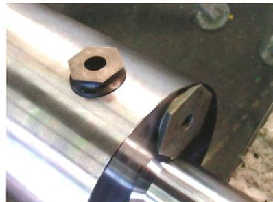
*Rotorwelle mit Schuko patentierten Schneidmessern: Spezielle Schuko-Schneidmesser mit Frei- und Schnittwinkeln sparen zirka 2 kW Motorleistung. Die mehrfach verwendbaren sechseckigen Messer mit sechs Schneidspitzen sichern nicht nur dauerhaft beste Schneideergebnisse, sondern senken aufgrund ihrer mehrmaligen Verwendbarkeit auch die Betriebskosten.*
