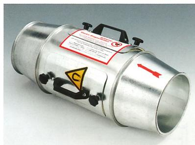
*Magnetabscheider (optional erhältlich): Nach dem Zerkleinerungsprozess entfernen starke Dauermagnete einen erheblichen Teil eventueller Metallteile wie Schrauben oder Nägel aus dem Spänestrom. Das schützt die Ventilatoren vor Beschädigungen. Auch ein sicherer Explosionsschutz ist so gewährleistet. Als weiteres Zubehör sind unter anderem verstärkte Rohrbögen aus 2 mm geschweißtem Stahl erhältlich.*
