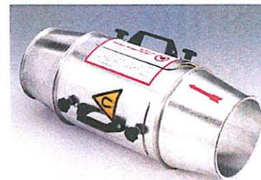
Magnetabscheider (optional erhältlich): Nach dem Zerkleinerungsprozess entfernen starke Dauermagnete einen erheblichen Teil eventueller Metallteile wie Schrauben oder Nägel aus dem Spänestrom. Das schützt die Ventilatoren vor Beschädigungen. Auch ein sicherer Explosionsschutz ist so gewährleistet. Als weiteres Zubehör sind unter anderem verstärkte Rohrbögen aus 2 mm geschweißtem Stahl erhältlich.
