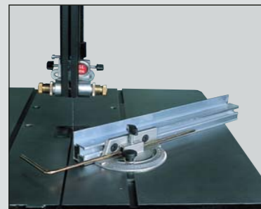
Squadretto per tagli angolati Gehrungslinéal Mitre quadrant Equerre pour coupes angulés Escuadra para cortes angulares
