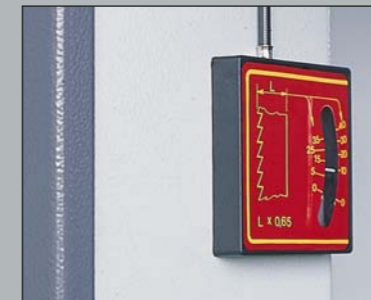
Indice tensione lama (Standard per paesi CEE) Blattspannungsanzeige (Standard für EU Länder) Blade tension indicator (Standard for EEC countries) Indicateur tension lame (Standard pour pays CEE) Índice tension hoja (Standard para países de la CEE)
