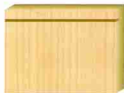
Fresature longitudinali per incastro pannello posteriore Longitudinal grooving to insert the rear panel Nutfräsung für Rückwand Fraisage longitudinal pour encastrement panneau postérieur Fresado longitudinal para encaje panel posterior
