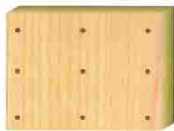
Foratura ortogonale al pannello con mandrini a discesa indipendente Face boring with independently lowering spindles Rechtwinklige Werkstückbohrung mit unabhängig arbeitenden Spindeln Perçage orthogonal au panneau avec mandrins à descente indépendante Taladros del panel con portabrocas que bajan independiente
