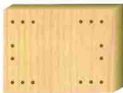
Foratura ortogonale al pannello con mandrini a discesa indipendente Face boring with independently lowering spindles Rechtwinklige Werkstückbohrung mit unabhängig arbeitenden Spindeln Perçage orthogonal au panneau avec mandrins à descente indépendante Taladros del panel con portabrocas que bajan independiente
