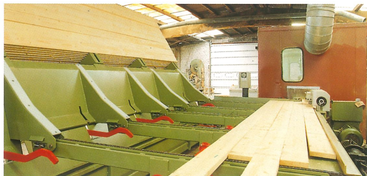
Høvelinnmateren Hydro 200 Fra tilten overføres emnene skånsomt til den hydrauliske høvelinnmateren. Denne sikrer en kontrollert mating av høvelen med kraft og sikkert anslag mot land/linjal.
