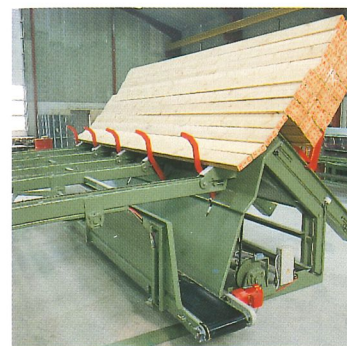
Pneumatisk mothold på tilt. Dette ekstrastyr sikrer at de enkelte lag kommer rolig ned på kjedebanene. Resultatet er støysvak drift uten kantskader.
