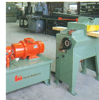
Høvelinnmater Hydro 150. Brukes for å sikre en kontinuerlig mating av høvelen. Hydro 150 gir dessuten en øket trekraft på opptil 150 kg. Hvis ønskelig kan Hydre 150 tvangsrette emnene i sideretningen.
