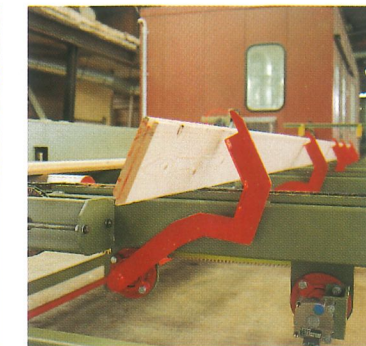
Programmerbar emnevender Kan brukes hvor alle emner skal vendes for visuell kvalitetsbedømmelse. Den kan programmeres til å vende enkelt emner eller i bestemte intervaller. Videre kan den vende annen hvert lag eller første og siste lag for skånsom emballering. I tillegg kan den betjenes manuelt for margvending og korrekt illegging.
