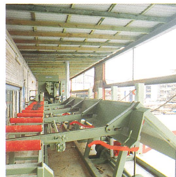
Stykkvis mating av båndsaag Anlegget kan bestå av tilt mateanlegg med halvautomatisk oppretting av store emner. Anlegget styres med hjelp av joy-stick slik at operatøren unngår tung løft og manuell håndtering av emnene.
