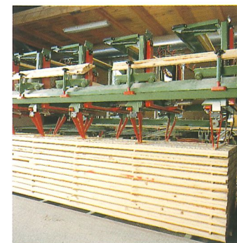
Automatisk strøleggingsutstyr. Dette kan leveres i forbindelse med høvelautomatisering. Systemet er programmerbart med hensyn til hvor ofte strø legges inn.
