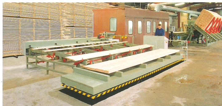
Dobbel kapasitet med halve mannskap. Muligheten finnes med denne høvelautomatisering. Denne kan klare inntil 80 meter pr. minutt med kun 1 mann.
