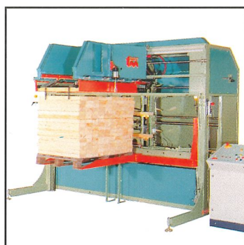
BS stabler for korte emner standard mellom 0,3 og 2,5 meter. Med en kapasitet på 30 emner pr. minutt er det en løsning som dekker de fleste behov. BS stableren er en prisgunstig maskin som øker effektiviteten og sparer mannskap.
