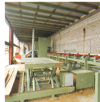
Utløpsbane fra båndsaag med tværravstrykningsystem og hjelpeutrustning for manuell stabling. Alt etter plassforhold kan systemet utbygges med automatisk retur for eventuell ytterligere gjennomløp.
